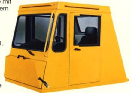
**Hervorragende Wartungsfreundlichkeit.** Eine abnehmbare Frontplatte gewährt leichten Zugang für die Wartung der Bremsventile und des Retarderventils. Im oberen Armaturenbrett wurden vier (4) abnehmbare Platten verwendet, auf denen Instrumente und kundenspezifische Sonderausrüstungen angeordnet und jeweils individuell zugänglich sind. Eine hinter dem Sitz angebrachte Abdeckung gestattet leichten Zugang zur Schaltung, zum CONTRONIC II Überwachungs-System sowie zu allen elektrischen Anschlüssen.
