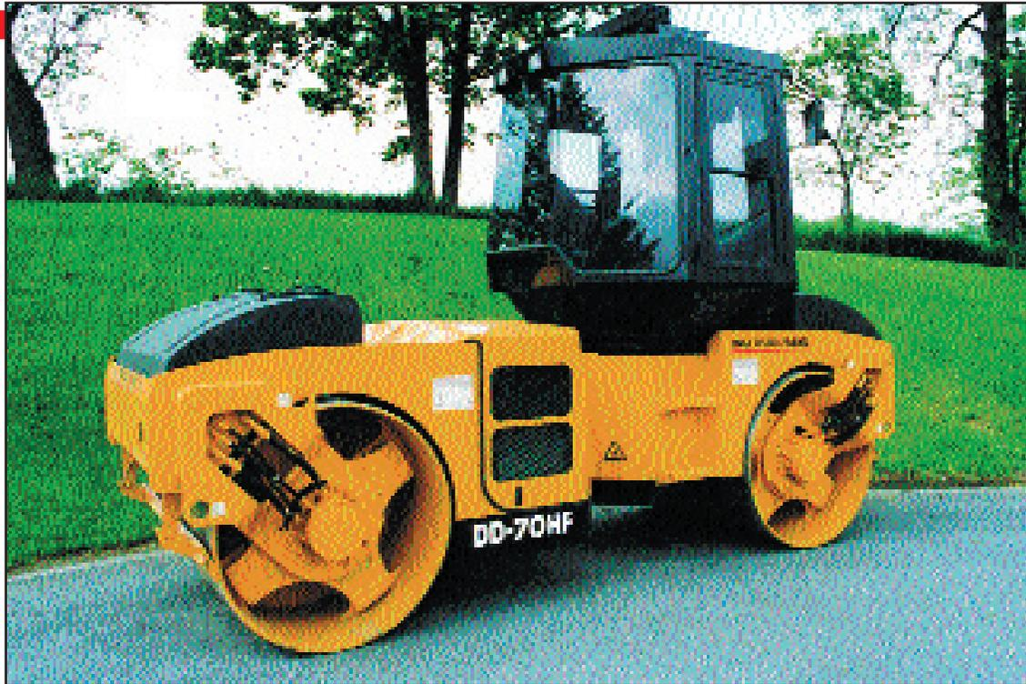
Die INGERSOLL-RAND verfügt über 1450 mm breite Bandagen vorn und hinten. Mit den bearbeiteten Bandagen und abgeschrägten Bandagenkanten wird eine optimale Ebenflächigkeit erzielt.
