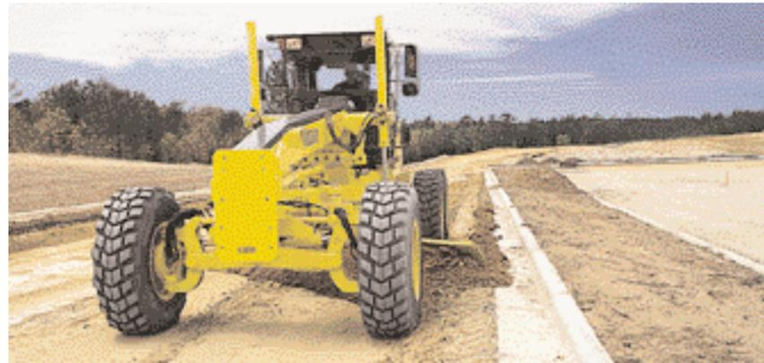
Cualquiera que sea su aplicación, el sistema de tracción en todas las ruedas de Volvo está concebido para la tarea. El sistema provee una distribución igual de potencia a través de unas bombas de caudal variable y motores independientes de alto par de torsión en cada rueda delantera. Si la tracción difiere en cualquier lado, el sistema asegura que todavía se logre la óptima potencia de empuje.
