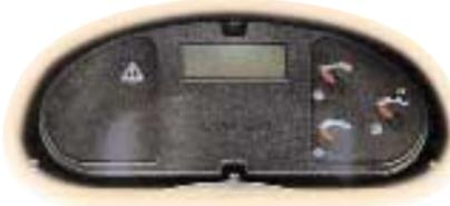
surveillance "Contronic". Ce système multi-fonctions renseigne l'opérateur sur l'état de toutes les fonctions de la machine, y compris le régime du moteur, sa température, le niveau de carburant, la vitesse de déplacement, l'obstruction du filtre, le blocage/déblocage du différentiel et bien d'autres. Le système "Contronic" informe l'opérateur de ce qui se passe dans la machine pendant qu'il s'en sert.
