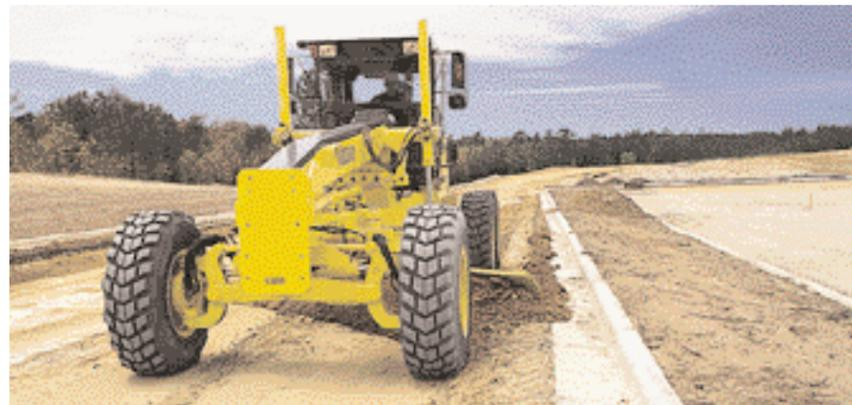
Quel que soit le travail à exécuter, le système Toutes Roues Motrices Volvo est adapté à la tâche. Le système fournit une répartition égale de la puissance au moyen de pompes à cylindrée variable et d'un moteur à couple élevé à chacune des roues avant. Si la situation diffère d'un côté ou de l'autre, ce système assure qu'on obtienne le maximum de puissance de traction.
