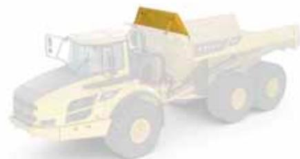
Specchi retrovisori regolabili e riscaldati elettronicamente
