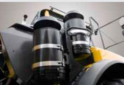
Système de remplissage rapide du carburant, kit boulonné
