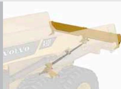
Chauffage de benne par les gaz d'échappement
