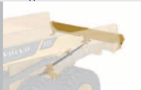
Подогрев кузова с помощью выхлопных газов
