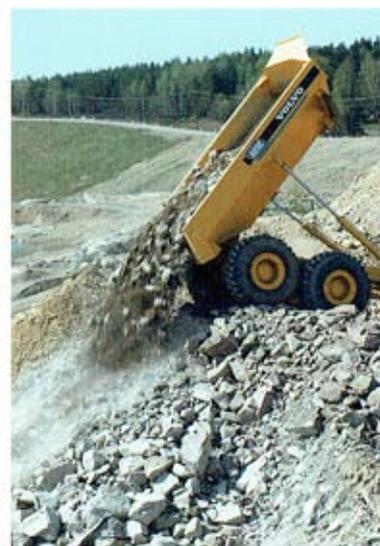
Un protège-cabine à l'avant met le conducteur à l'abri, une porte arrière commandée par câble réduit le risque de chute pendant le transport. Le chauffage du fond de la benne fait que la charge ne colle pas dans certaines conditions de conduite. Du fait que ce chauffage est assuré par les gaz d'échappement, il ne consomme aucune énergie supplémentaire.
