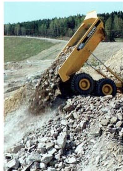
Ladung dienen der vorderseitige Überlaufschutz, der das Herabfallen von Material auf Kabine und Fahrer verhindert, sowie die Heckklappe zum Zurückhalten von Ladegut beim Transport. Die Heizung im Muldenboden (vorbereitet) entwickelt einen sehr guten Anti-Haft-Effekt vor allem bei Frost. Weil Abgaswärme genutzt wird, ist zusätzliche Energie nicht erforderlich.
