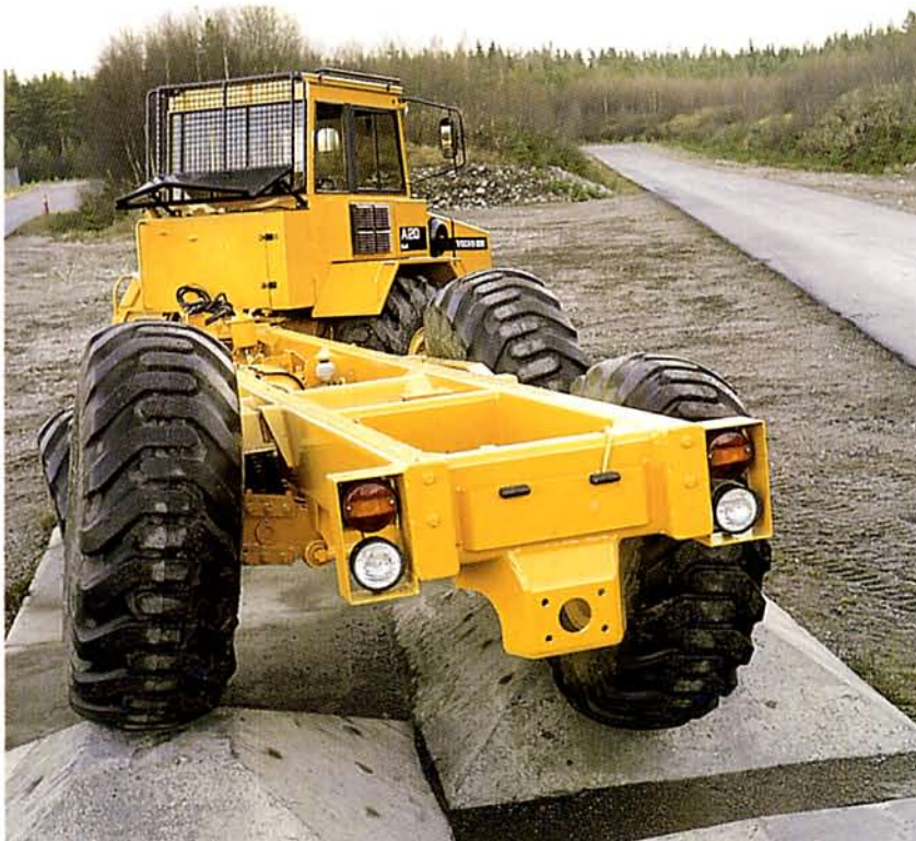
Volvo BMs unika terrängboggie-system med oberoende axelfjädring, som klarar höga hinder utan chassirörelser.
