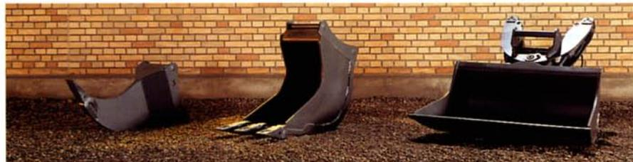
Das Geräteprogramm erweitert Ihr Einsatzspektrum, z.B. unser Löffelsortiment – vom Schmallöffel bis zum Böschungslöffel – für den Direktanbau oder den Schnellwechsler, der in zwei Ausführungen zur Verfügung steht.
