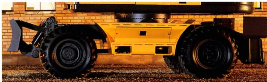
Der Unterwagen des Mobilbaggers ist äußerst vielseitig: Sie können mit oder ohne Abstützung arbeiten, mit vier Stützpratzen (die einzeln, gleichzeitig oder paarweise bedient werden können), mit Planierschild vorne und Stützpratzen hinten, mit Planierschild vorne und hinten oder nur mit Planierschild hinten ... ganz wie es der Einsatz erfordert. Für die Räder stehen u.a. auch extrem breite Reifen zur Auswahl.
