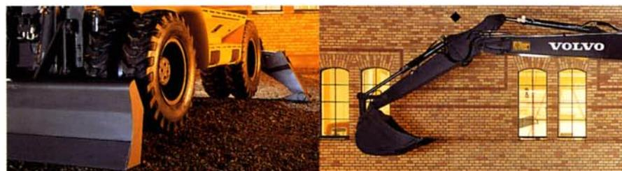
Die beweglichen Stützpratzen mit Sperre steigern die Standsicherheit und schonen den Boden. Gute Bodenfreiheit, Differentialsperre und pendelnde Vorderachse (9°) tragen zu den vorzüglichen Geländeeigenschaften bei.
