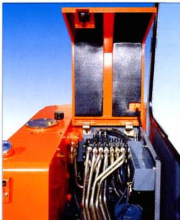
Eine breite Haube ermöglicht den Zugang zu allen zentral angeordneten hydraulischen Elementen der Maschine. Der Steuerblock, die Drehdurchführung und der Drehwerkmotor sind unmittelbar zugänglich, hierdurch sind sämtliche Wartungs- und Einstellarbeiten einfach auszuführen.
