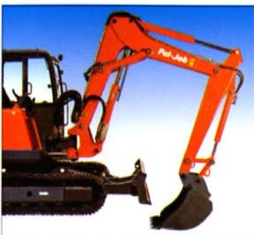
Der neue Verstellausleger macht den EB 706 noch vielseitiger. Durch das zusätzliche Auslegergelenk wird der Raumbedarf der Ausrüstung reduziert, und der Löffel kann auf einer größeren Bodenfläche und in unmittelbarer Nähe der Maschine platziert werden.
