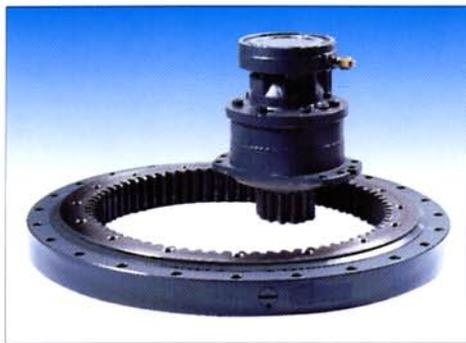
Einzig bei Pel-Job : Der langsame Drehwerkmotor mit Radialkolben. Dieser Motor verfügt über ein sehr hohes Anlaufdrehmoment, welches flexibles schwenken ermöglicht, und treibt den Kugeldrehkranz direkt und ohne zwischengeschaltetes Reduktionsgetriebe an. Folge : weniger Verschleiß, da weniger bewegliche Teile. Die in den Drehwerkmotor integrierte Bremse blockiert den Oberwagen in jeder gewünschten Position und garantiert eine optimale Arbeitssicherheit, dies selbst in Schräglage.
