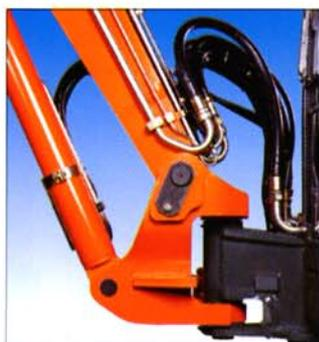
Das robuste Drehgelenk des Auslegers erlaubt eine Armversetzung von Total 130°. Das Gelenk mit Doppelgabelführung und der lange Bolzen erhöhen die Starrheit der Verbindung. Alle Bolzen sind mit Bund versehen um die Dichtheit gegen Fettverlust zugewährleisten und die Wartungsintervalle zu verlängern.
