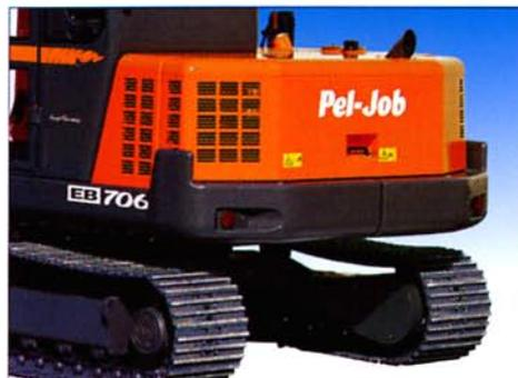
Die abgerundete Form des Kontergewichtes schützt die Heckpartie und ermöglicht Arbeiten auf kleinstem Raum.
