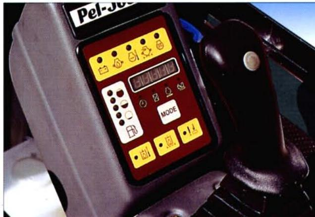
Der in dem EB 706 integrierte Bordcomputer PUMA überwacht ständig alle wesentlichen Maschinenfunktionen und informiert den Fahrer unverzüglich im Falle einer Störung. Der Fahrer kann durch diese entfallenden Kontrollfunktionen seine gesamte Aufmerksamkeit auf die Bedienung der Maschine richten.
