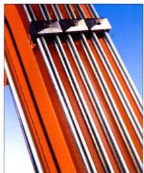
Une protection très efficace contre la corrosion : toute la boulonnerie, les axes et les tuyaux hydrauliques sont zingués et bichromatés.
