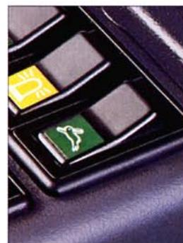
L'EB 506 est équipée en standard de deux vitesses de translation dont une vitesse rapide pour accélérer les déplacements de la machine sur le chantier.
