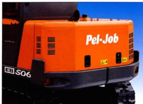
Parce que certains chocs sont malheureusement inévitables, le contrepois enveloppant protège l'arrière de la machine. Le capot en acier est monté en retrait par rapport au contrepois pour améliorer sa protection.
