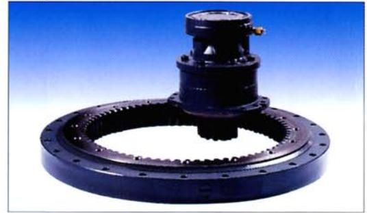
Une exclusivité Pel-Job : le moteur d'orientation lent à pistons radiaux. Ce moteur dispose d'un très fort couple au démarrage, pour des manoeuvres tout en souplesse et entraîne directement la couronne sans réducteur mécanique. Résultat : moins de pièces en mouvement et donc moins de risques d'usure. Le frein hydraulique automatique intégré au moteur d'orientation immobilise la tourelle dans toutes les positions et garantit une sécurité de travail optimale même en dévers.
