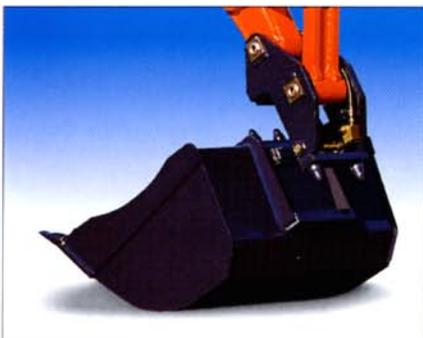
Le système d'attache rapide permet de changer d'accessoire ou de godet sans quitter le poste de conduite. Apprécié de tous les utilisateurs, ce dispositif offre un gain de temps et de confort appréciable sans modifier les performances ni la cinématique du godet.
