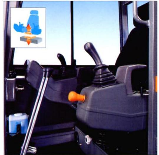
Les commandes hydrauliques sont assistées et très progressives pour plus de souplesse et de précision. Les nouveaux manipulateurs ergonomiques Pel-Job tombent bien en main et sont complétés dans leur prolongement par des accoudoirs latéraux qui assurent une position de conduite naturelle et très confortable.
