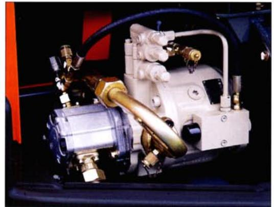
Régulation Load-Sensing continue et immédiate du débit et de la pression de la pompe hydraulique en fonction du travail de la pelle.
