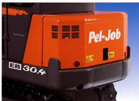
Sabiendo que algunos golpes son inevitables, el contrapeso envolvente protege la parte trasera de la máquina. El capó de acero está montado de modo que el contrapeso le protege.
