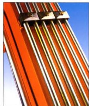
Una protección muy eficaz contra la corrosión: todos los pernos, ejes y tubos hidráulicos están galvanizados con zinc y bicromatados para que su mini-excavadora mantenga durante largos tiempos el aspecto del primer día.
