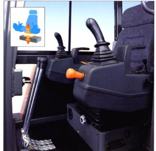
Las consolas laterales que llevan los mandos hidráulicos son solidarias con la suspensión del asiento : la precisión de la conducción queda independiente de los movimientos de la máquina, y el conductor está seguro de encontrar una posición de conducción idealmente adecuada a su morfología.
