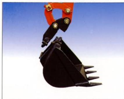
El porta implemento permite cambiar de accesorio o del cazo sin abandonar el puesto de conducción. Este dispositivo, apreciado por todos los usuarios, proporciona una economía de tiempo y un aumento de confort considerables sin merma de las prestaciones ni de la cinemática del cazo.
