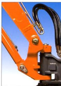
Flexibles con sobrefunda (seguridad para el conductor) centrados a nivel de la flecha: Acceso y mantenimiento fáciles, mejor visibilidad y seguridad de utilización (sin riesgos de enganches). La pluma está montada sobre un pivote articulado de doble horquilla que permite el montaje de un eje largo y asegura una mayor rigidez de la unión pluma-chasis. El vástago de cilindro de pluma está totalmente protegida contra los choques eventuales por un sólido blindaje.
