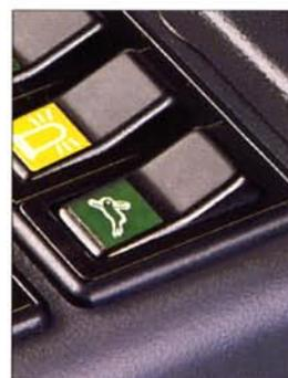
La EB 30.4 está equipada en la versión estándar con dos velocidades de traslación, una de ellas rápida para acortar los desplazamientos de la máquina en la obra.
