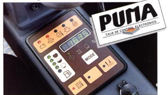
El ordenador de a bordo que equipa la EB 30.4 controla permanentemente todas las funciones vitales de la máquina, e informa enseguida al conductor en caso de fallo. Este conserva la mente libre y puede pues dedicarse plenamente a conducir su máquina.
