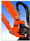
Tous les flexibles de l'équipement sont libres et gainés donc sans frottement ni usure et sont raccordés en pied de flèche pour un remplacement très rapide si nécessaire. La flèche est montée sur un pivot aticulé à double chape qui permet le montage d'un axe long et assure une plus grande rigidité de la liaison flèche-châssis. La tige du vérin de flèche est intégralement protégée contre les chocs éventuels par un robuste blindage.
