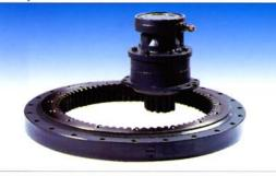
Une exclusivité Pel-Job : le moteur d'orientation lent à pistons radiaux. Ce moteur dispose d'un très fort couple au démarrage, pour des manoeuvres tout en souplesse et entraîne directement la couronne sans réducteur mécanique. Résultat : moins de pièces en mouvement et donc moins de risques d'usure. Le frein hydraulique automatique intégré au moteur d'orientation immobilise la tourelle dans toutes les positions et garantit une sécurité de travail optimale même en dévers.
