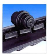
Le confort de roulement est nettement amélioré grâce au profil des chenilles et à la position alternée des guides qui assure un contact permanent avec les galets.
