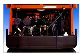
Le large capot insonorisé à ouverture totale offre une excellente accessibilité au moteur: tous les points d'entretien et de vérification tombent sous la main pour gagner du temps.La capacité du réservoir gasoil permet une très grande autonomie d'utilisation.
