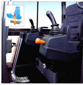
Les consoles latérales portant les manipulateurs sont solidaires de la suspension du siège : la précision de conduite est indépendante des mouvements de la machine et le conducteur est sûr de trouver une position de conduite idéalement adaptée à sa morphologie.
