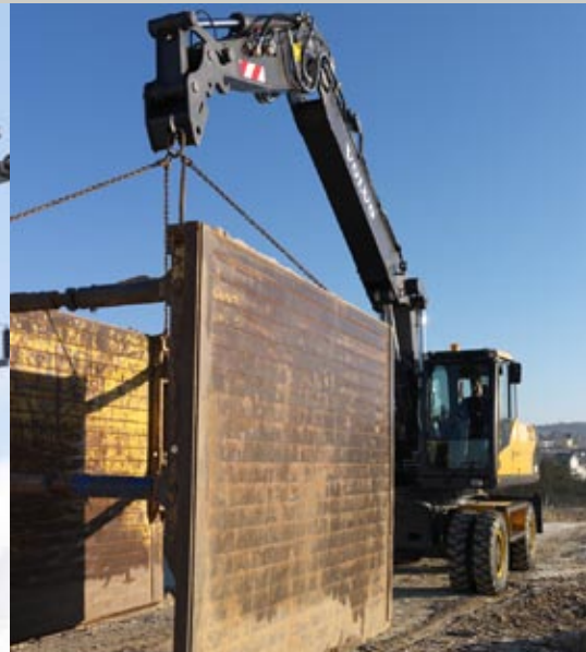
• La capacidad de elevación rivaliza con la de una excavadora de cadenas de 24 toneladas.
