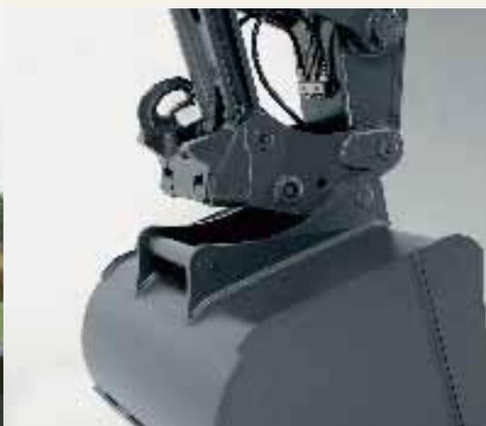
• Attacco rapido: facile cambio delle attrezzature direttamente dalla cabina.
