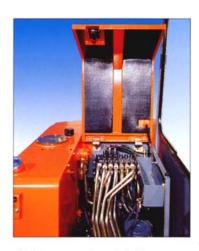
Un large capot central dégage une plate-forme de service où sont regroupés tous les composants hydrauliques de la machine. L'accès aux distributeurs, au joint tournant et au moteur d'orientation est immédiat, ce qui facilite grandement toutes les opérations de maintenance.
