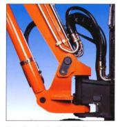
Le robuste pivot de flèche assure un débattement total de 130°. L'articulation à double chape et l'axe long contribuent à la rigidité de l'ensemble. Tous les axes sont bagués pour assurer l'étanchéité de la graisse et augmenter les intervalles d'entretien.
