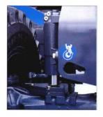
Le pont avant directeur est oscillant avec un débattement de 15° pour passer sur tous les terrains. Un dispositif hydraulique de blocage de l'oscillation assure une stabilité parfaite de la pelle dans toutes les positions.
