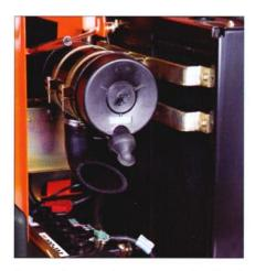
Les radiateurs du moteur et du circuit hydrauliques sont placés côte à côte pour faciliter leur nettoyage. La batterie et le filtre à air sont eux aussi très facilement accessibles.
