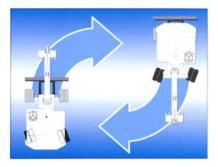
Le système Pel-Job Auto-Reverse disponible en option inverse automatiquement le sens de la direction lorsque la tourelle est orientée vers l'arrière. Grâce à ce système exclusif, les roues directrices sont toujours braquées dans le sens de rotation du volant, pour plus de précision et de sécurité dans la conduite.
