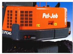
La forme enveloppante du contrepoids protège parfaitement l'arrière de la machine et permet de travailler sur les chantiers les plus étroits.
