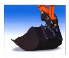
Une exclusivité Pel-Job : le système d'attache rapide permet de changer d'accessoire ou de godet sans quitter le poste de conduite. Apprécié de tous les utilisateurs, ce dispositif offre un gain de temps et de confort appréciable sans modifier les performances ni la cinématique du godet.
