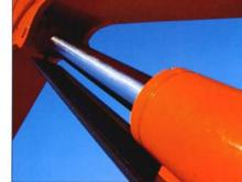
La qualité Pel-Job jusque dans les moindres détails : les conduites hydrauliques sont zinguées et bichromatées pour une meilleure protection contre la corrosion et montées sur la partie supérieure de la flèche à l'abri des chocs. La tige du vérin de flèche est intégralement protégée contre les chocs éventuels par un robuste blindage. Chaque vérin est largement dimensionné et équipé d'amortisseurs de fin de course pour plus de souplesse.
