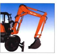
La nouvelle flèche à volée variable renforce la polyvalence de l'EB 706. L'articulation supplémentaire de la flèche permet de réduire l'encombrement de l'équipement et de positionner le godet sur un plus grande surface au sol, même à proximité immédiate de la machine.
