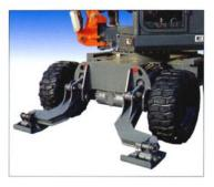
L'EB 706 est équipée en standard d'une robuste lame actionnée par deux vérins pourvus de clapets de sécurité. Celle-ci peut être remplacée en option par deux stabilisateurs commandés séparément su lesquels peut être ajoutée une lame amovible.
