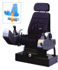
Les consoles latérales portant les manipulateurs sont solidaires de la suspension du siège : la précision de conduite est indépendante des mouvements de la machine et le conducteur est sûr de trouver une position de conduite idéalement adaptée à sa morphologie.
