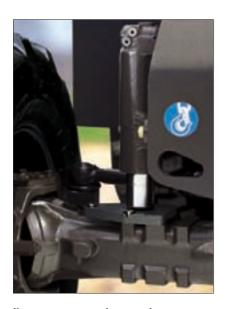
Il ponte anteriore direttore ha un'oscillazione di 15° per potere passare su ogni tipo di terreno. Un dispositivo idraulico di bloccaggio dell'oscillazione assicura una perfetta stabilità dell'escavatore in tutte le posizioni.
