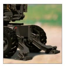
Il modello standard EW70 è dotato di una robusta lama azionata da due martinetti con valvole di sicurezza. Essa può essere sostituita come optional da due stabilizzatori comandati separatamente sui quali si può aggiungere una lama amovibile.
