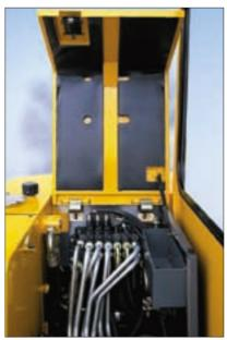
Un ampio cofano centrale offre una piattaforma di servizio incomparabile sulla quale tutti i componenti idraulici della macchina sono raggruppati. L'accesso ai distributori, al giunto girevole ed al motore di orientazione è immediato, ciò facilita molto tutte le operazioni di manutenzione.
