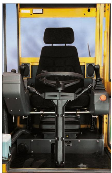
Manipolatori ergonomici : eccellente maneggevolezza della macchina, precisione di ogni movimento, importante guadagno di tempo. Un sedile sospeso con varie posizioni, regolabile indipendentemente dai manipolatori.
