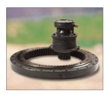
Un'esclusività: il motore d'orientazione lento a pistoni radiali. Questo motore dispone di una coppia molto forte all'avviamento, per manovre in flessibilità e avanza direttamente la ralla senza riduttore meccanico. Risultato: meno pezzi in movimento quindi meno rischi di usura. Il freno idraulico automatico integrato al motore d'orientazione immobilizza la torretta in ogni posizione e garantisce una sicurezza di lavoro ottimale anche in pendenza.
