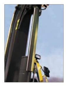
Tubazioni munite di super guaina (sicurezza per l'operatore), centrate a livello del braccio : accessibilità, manutenzione agevolata, migliore visibilità e sicurezza di impiego (senza rischi di agganciamenti). Il braccio è montato su un giunto articolato a doppia forcella che permette il montaggio di un perno lungo e assicura una maggiore rigidità all'accoppiamento braccio-telaio. Il perno del martinetto del braccio è integralmente protetto contro gli urti eventuali da una blindatura robusta.
