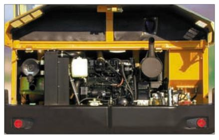
Il cofano posteriore ad apertura totale offre un accesso ampio sul motore e sulle pompe idrauliche. Tutti i punti di manutenzione e di controllo sono idealmente situati a portata di mano.
