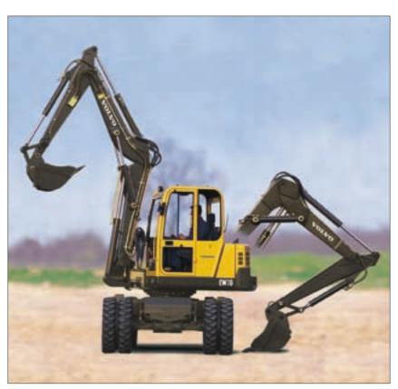
Il braccio a triplice articolazione aumenta la polivenza dell'EW70 : permette di ridurre l'ingombro dell'attrezzatura e di posizionare la benna su diuna maggiore area al suolo, anche in prossimità della macchina stessa.
