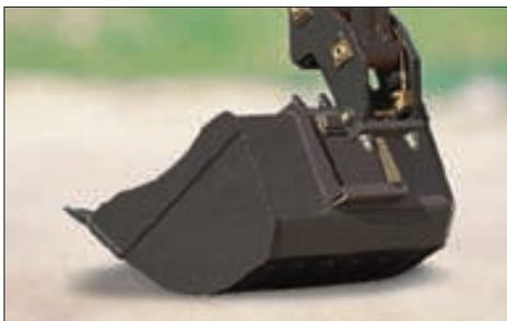
Una exclusividad : el portaimplemento permite cambiar de accesorio o de cuchara sin abandonar el puesto de conducción. Este dispositivo, apreciado por todos los usuarios, proporciona una economía de tiempo y un aumento de comodidad considerable sin merma de las prestaciones ni de la cinemática del cazo.
