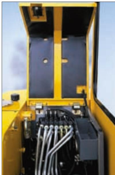
Un amplio capó central libera una plataforma de servicio, en la que se encuentran agrupados todos los componentes hidráulicos de la máquina. Es inmediato el acceso a los distribuidores, a la junta giratoria y al motor de orientación, lo que facilita mucho todas las operaciones de mantenimiento.
