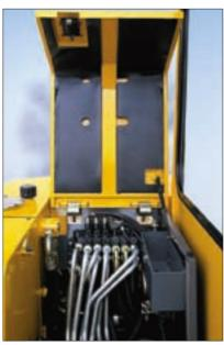
Un ampio cofano centrale offre una piattaforma di servizio incomparabile sulla quale tutti i componenti idraulici della macchina sono raggruppati. L'accesso ai distributori, al giunto girevole ed al motore di orientazione è immediato, ciò facilita molto tutte le operazioni di manutenzione.
