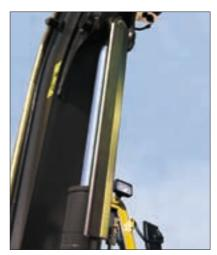
Tubazioni munite di super guaina (sicurezza per l'operatore), centrate a livello del braccio: accessibilità, manutenzione agevolata, migliore visibilità e sicurezza di impiego (senza rischi di agganciamenti). Il braccio è montato su un giunto articolato a doppia forcella che permette il montaggio di un perno lungo e assicura una maggiore rigidità all'accoppiamento braccio-telaio. Il perno del martinetto del braccio è integralmente protetto contro gli urti eventuali da una blindatura robusta.
