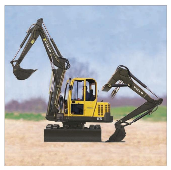
Il braccio a triplice articolazione aumenta la polivenza dell'EC70 : permette di ridurre l'ingombro dell'attrezzatura e di posizionare la benna su di una maggiore area al suolo, anche in prossimità della macchina stessa.
