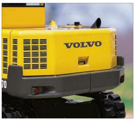
La forma avvolgente del contrappeso protegge perfettamente la parte posteriore della macchina e permette di operare nei cantieri più stretti.
