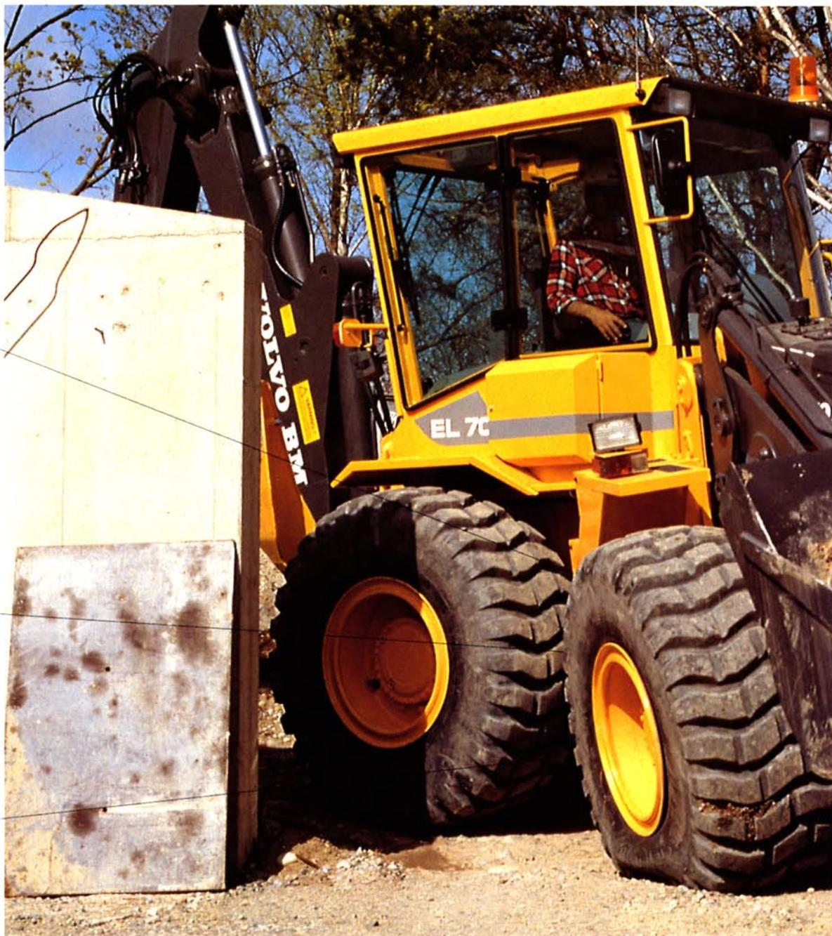
El cojinete superior de la articulación del bastidor y el eslabon pendular bloqueable inferior permiten el giro vertical de los bastidores entre si.
