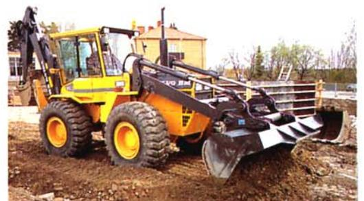
*La cuchara puede inclinarse  $114^\circ$  hacia adelante y  $51^\circ$  hacia atrás en la posición de acarreo.*
