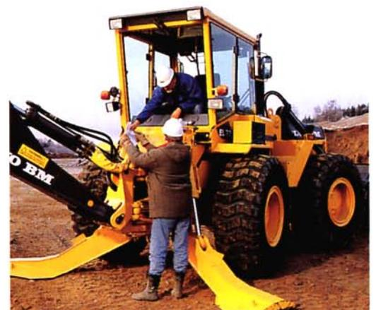
*Gracias a las ventanillas laterales abribles y al cristal trasero plegable, el conductor tiene buen contacto con el personal exterior a la máquina.*
