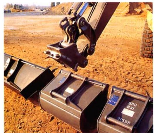
*Hay dos modelos de portaimplemento para la excavadora: de accionamiento hidráulico desde la cabina o de bloqueo mecánico con llave.*
