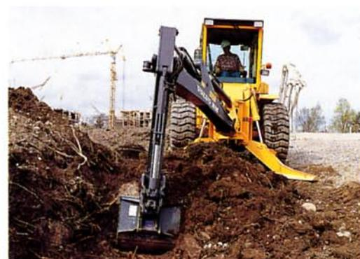
*La angulación del equipo de excavación es totalmente progresiva. Se obtiene, en cualquier posición, el mejor ángulo de excavación.*
