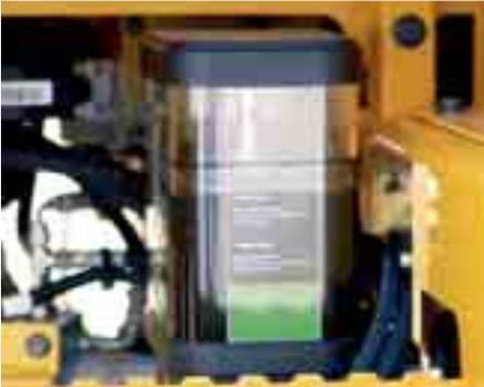
**Système de graissage centralisé automatique\***
