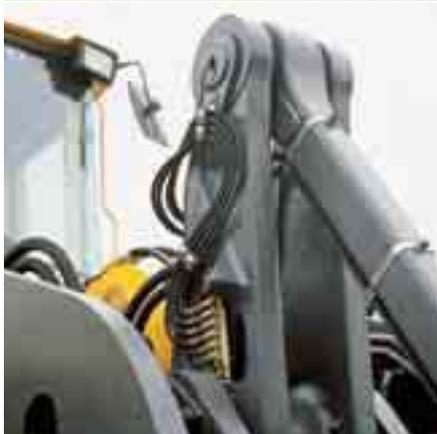
**Système de graissage centralisé automatique\***
