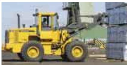
*Kleiner Wenderadius und exakte Load Sensing-Lenkung erleichtern Präzisionsarbeiten in beengten Räumen.*
