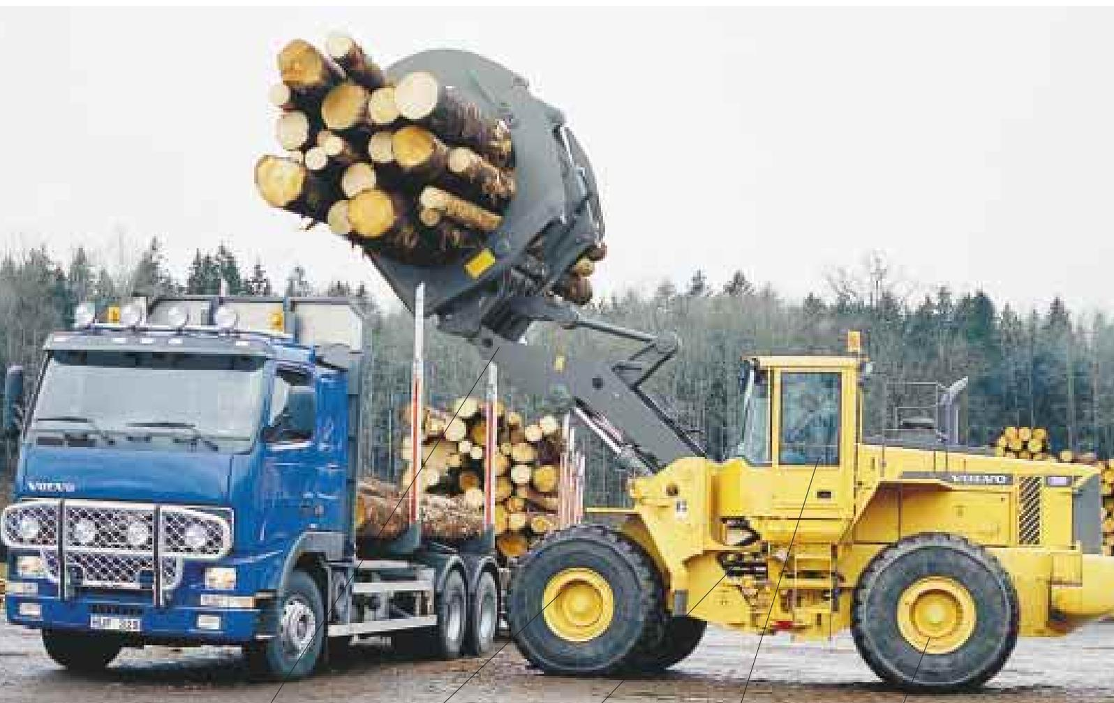
*Durch das patentierte TP-Hubgerüst wird der Schwerpunkt der Last sehr nahe an der Maschine plziert. So nimmt die Standfestigkeit zu, und die zulässige Kipplast kann optimal genutzt werden.*
