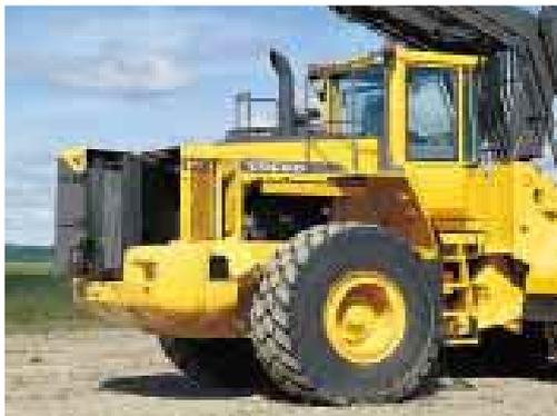
*Aufklappbare Motorabdeckungen mit Gasfederstützen und mit dem Kühler ausschwenkbare Kühlerhaube vereinfachen die Reinigung.*
