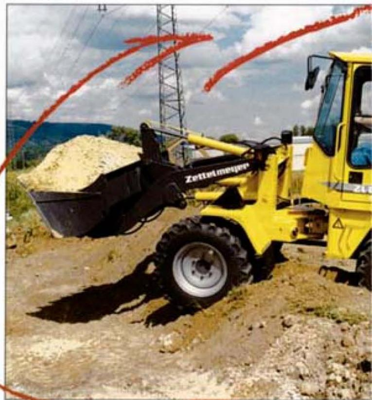
Z-Kinematik die robuste Vielzweck-Kinematik mit den hohen Reiß- und Hubkräften. Kraftvoll in Verladung und Produktion.
