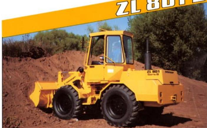
**Alliance de la puissance et de la protection de l'environnement.** La ZL 801 B dispose d'un moteur Deutz de la nouvelle série 1011 et d'une nouvelle transmission hydrostatique qui rendent encore plus efficace la puissante cinématique Z. Avec une attache rapide hydraulique en option, la ZL 801 B se présente comme une machine universelle.
