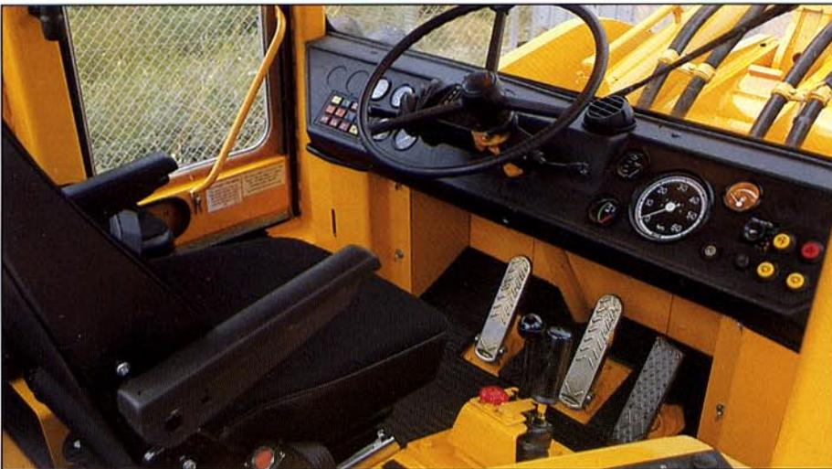
Die serienmäßige Ausstattung der überrollsicheren, großräumigen ROPS-Kabine mit Sicherheitsgurt, motorunabhängiger Heizung, getöntem Sicherheitsglas und Radio, macht den ZL 4001 Serie B zu einem jederzeit sicheren und angenehmen Arbeitsplatz.
