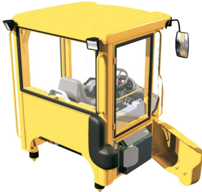
la dirección de palanca, (CDC)\*, el operador acciona la dirección, el cambio de marcha adelante y atrás, y la función de kick-down, accionando un mando en el reposabrazos. En cualquier momento, el operador puede cambiar entre el volante y la palanca de dirección, eliminando así los movimientos monótonos. Esto le brinda al operador la posibilidad de variar su forma de conducir, reduciendo así los esfuerzos estáticos del cuerpo.
