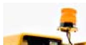
**Il lampeggiante di sicurezza** con luce alogena stroboscopica a lampeggiamento rapido migliora la visibilità anche in condizioni molto polverose.
