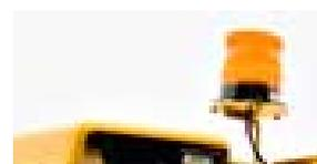
**Gyrophare** avec ampoule halogène et rotation rapide pour une luminosité puissante même dans un environnement poussiéreux.
